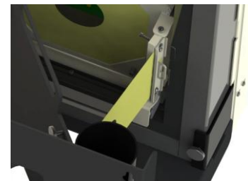
Vue du cadre de mesure avec le changeur de cible installé
